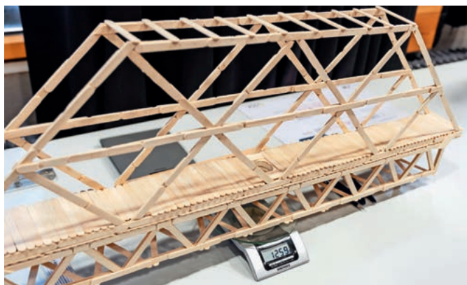
5 | Gewichtskontrolle: Die Brücken dürfen nicht schwerer als 1,5 kg sein. 5 | Contrôle du poids: les ponts ne doivent pas peser plus de 1,5 kg.
