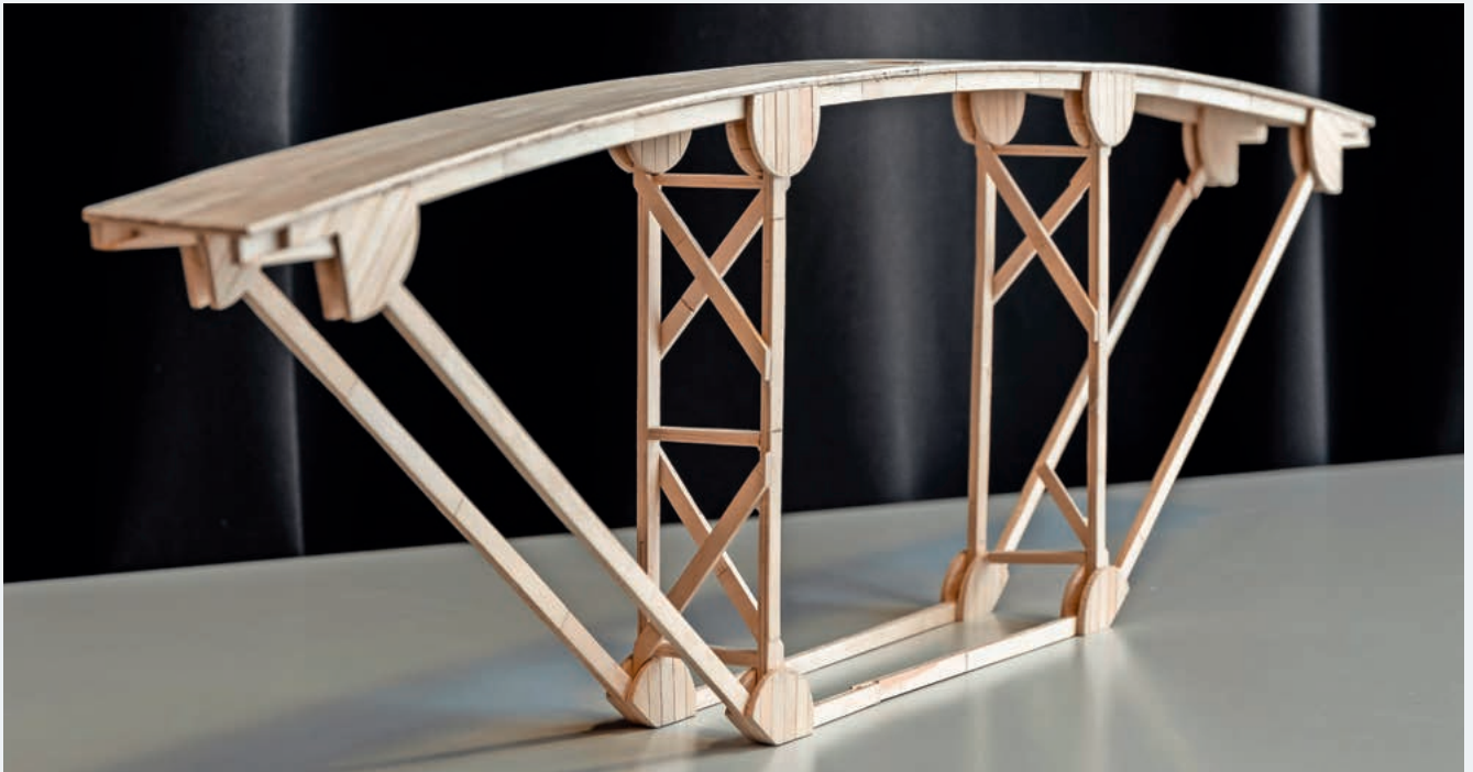
1 | Die effektivste Brücke des Brückenbau-Wettbewerbs 2019: Sie brach erst unter Last von 483 Kilogramm bei einem Eigengewicht von lediglich 490 Gramm. 1 | Le meilleur pont conçu en 2019: d'un poids de seulement 490 grammes, il a fallu une charge de 483 kg pour qu'il atteigne son point de rupture.
